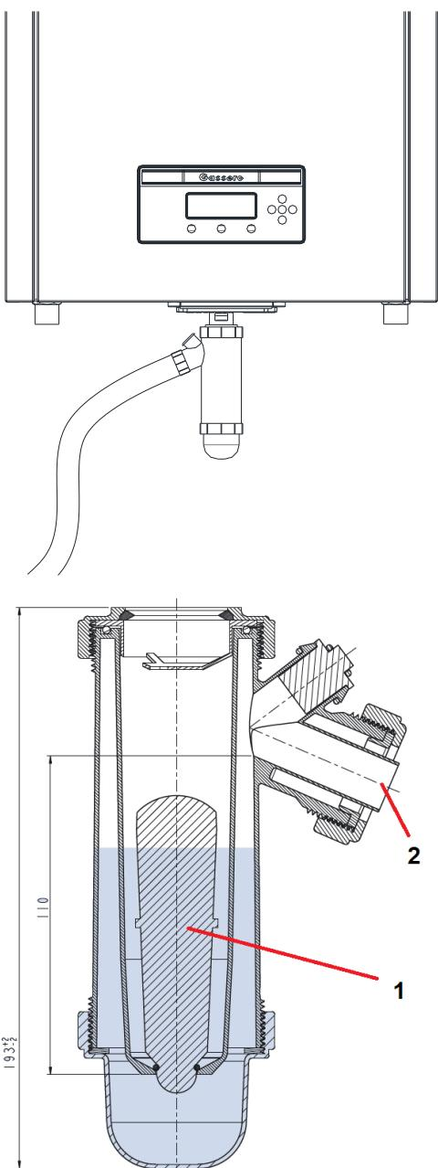
Конденсат, образующийся в процессе сгорания, сливается в систему канализации через сифон и дренажный шланг. Подключение дренажного шланга к системе канализации должно быть выполнено с созданием постоянного уклона и разрывом потока. В качестве альтернативы подключить сливной шланг к устройству нейтрализации конденсата.
