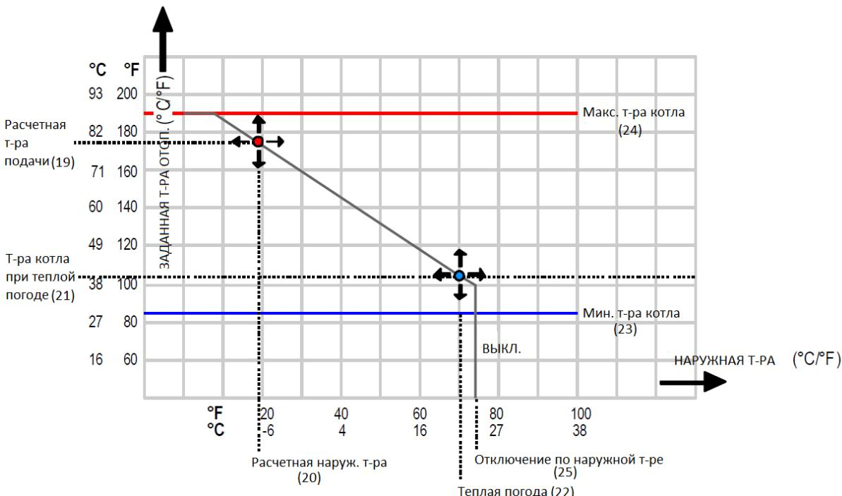
Кривую погодозависимой теплогенерации можно изменить, отрегулировав расчетную температуру и температуру для теплой погоды.
