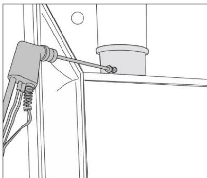
Подключите газоанализатор к измерительному штуцеру на адаптере дымохода.
