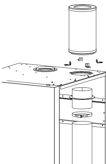
Если ALUCON будет эксплуатироваться в запыленной окружающей среде, то котел должен быть оборудован фильтром входящего воздуха. Этот дополнительный фильтр должен регулярно проверяться.
