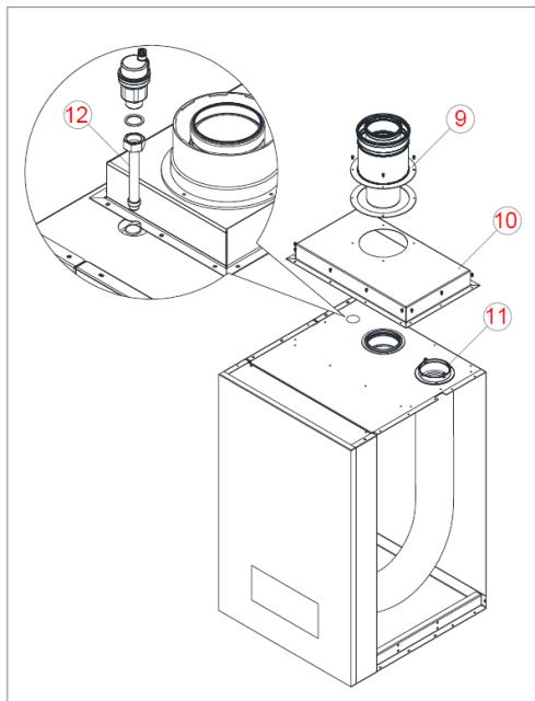
Если в котлах модели ALLUCON применяется соединение дымохода типа С13, С33 (коаксиальный); Используйте комплект коаксиального дымохода
