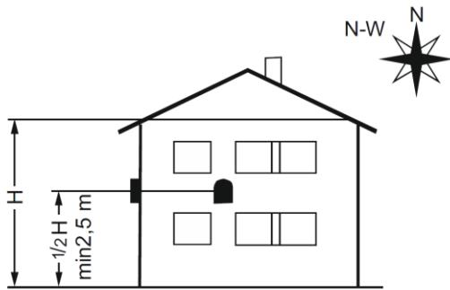
При применении датчика наружной температуры котел автоматически изменяет температуру подачи теплоносителя согласно наружной температуре. Это позволяет существенно экономить энергию без потери комфорта в отапливаемом помещении.
