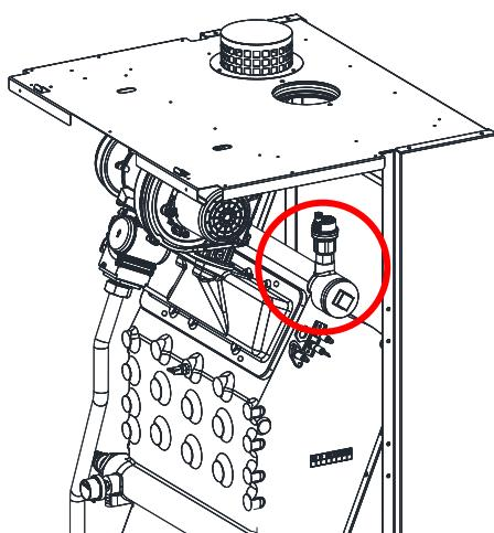
Водогрейные конденсационные котлы **ALUCON** оборудованы автоматическими воздухоотводчиками.
