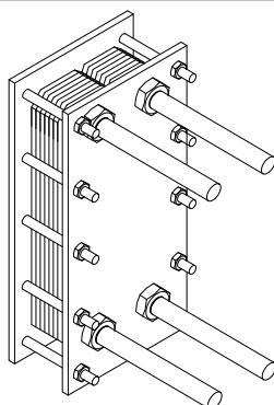
Пластинчатый теплообменник – это элемент системы, который физически разделяет систему отопления и водогрейный котел на первичный и вторичный контуры.
