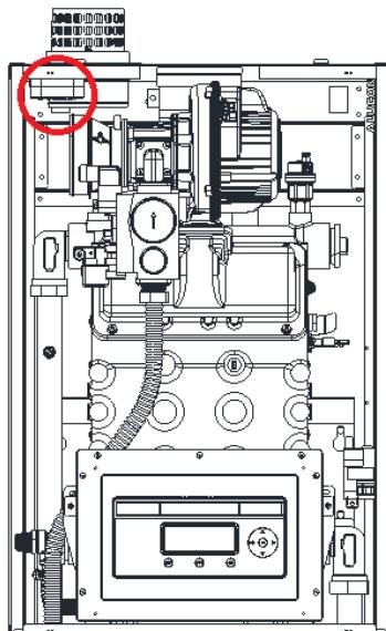
Водогрейные конденсационные котлы **Alucon** оборудованы реле давления воздуха, подключенным к патрубку дымоудаления.
