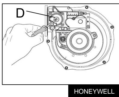
Поверните винт регулировки минимального расхода газа (D) по часовой стрелке, чтобы увеличить значение CO<sub>2</sub>. Если вы повернете его против часовой стрелки, расход газа уменьшится и, следовательно, количество CO<sub>2</sub> тоже уменьшится.
