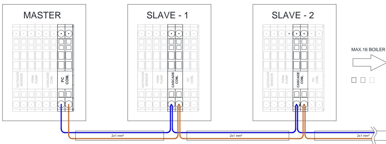
Только на контроллере ведущего котла DIP-переключатель S1, расположенный в правом нижнем углу контроллера, переключается из положения ВЫКЛ в положение ВКЛ (сдвигается вправо).
