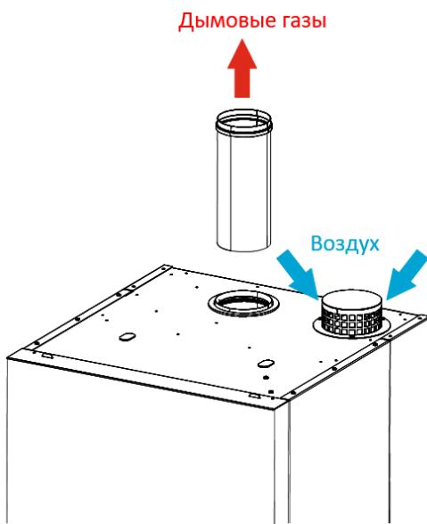
Если необходимо использовать соединение дымохода типа В23, следует использовать переходник для всасывания чистого воздуха, а отработанный газ следует отводить во внешнюю среду через трубу Ø100 мм.
