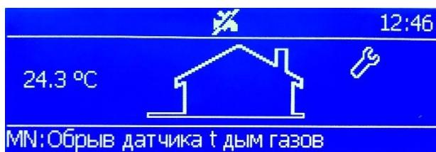
Котлы **Wallcon** оснащены системой диагностики неисправностей.
