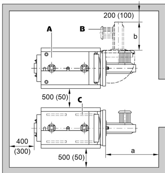
Для упрощения монтажа и выполнения работ по техобслуживанию должны соблюдаться указанные размеры. При ограниченном пространстве для монтажа достаточно выдержать минимальные расстояния (указанные в скобках). В состоянии при поставке дверь котла смонтирована таким образом, что открывается влево. Шарнирные болты можно переставить так, чтобы дверь котла открывалась вправо.
