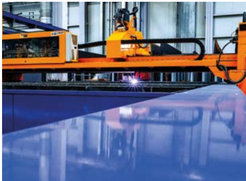
Плазменная резка металла. Раскрой металлических листов с высокой точностью, макс. размеры 4000x13000 и 4000x9000мм, толщина металла до 80мм. Резы могут производиться не только вертикально, но и под углом, сразу создавая фаску
